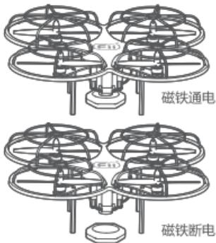
飞行器控制磁铁通电/断电
